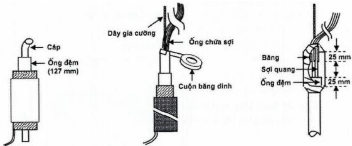
Hình C.8 - Chuẩn bị đầu cáp
