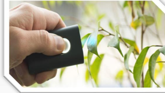
Thiết bị SCiO phát hiện hoá chất trong thực phẩm nông nghiệp
